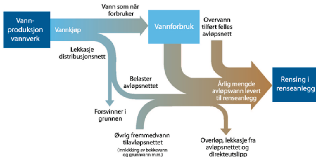
Figur 7.5. Illustrasjon av utfordringen med lekkasjetap av drikkevann fra vannledningsnett og overvannstilførsler til avløpsnett. (Kilde hovedplaner fra Drammensregionen og Stavanger)
